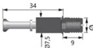
Con mecanización estándar, este perno consigue la máxima fuerza, comparable al uso de tuercas de embutir. Sus diámetros 8 y 10 permiten su aplicación en todo el rango de espesores de tablero.
